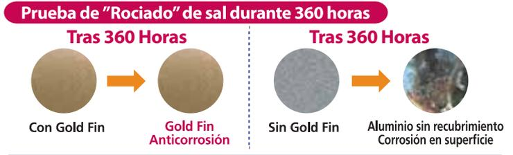
Resultado de Prueba de Sal Spray : 360 horas [Test Standard : KS D 9502, ASTM]
